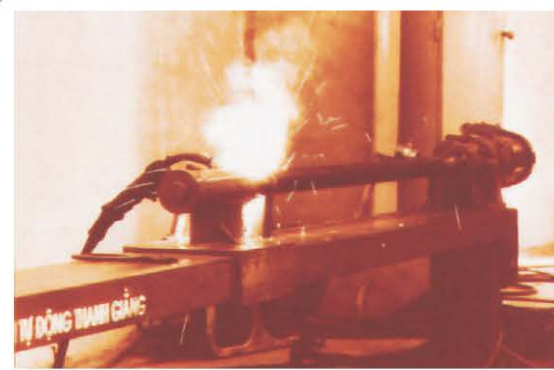
Hàn tự động các thanh giàn bằng dây hàn độ bền cao, khí bảo vệ CO 2
