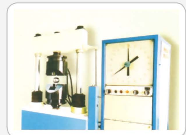
Thiết bị kiểm tra liên kết bu lông và nút cầu
