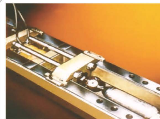
Thiết bị kiểm tra liên kết bu lông và nút cầu
